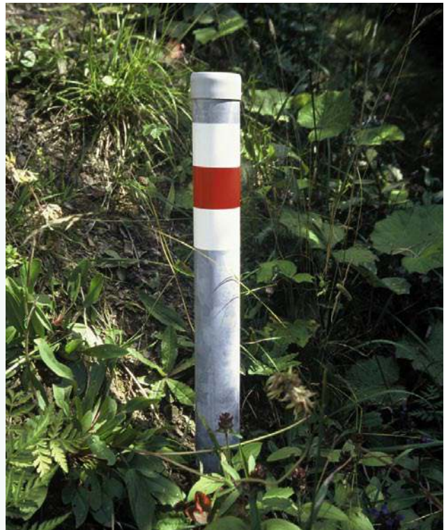
Eingeschlagenes Eisenrohr als Markierungsstange
