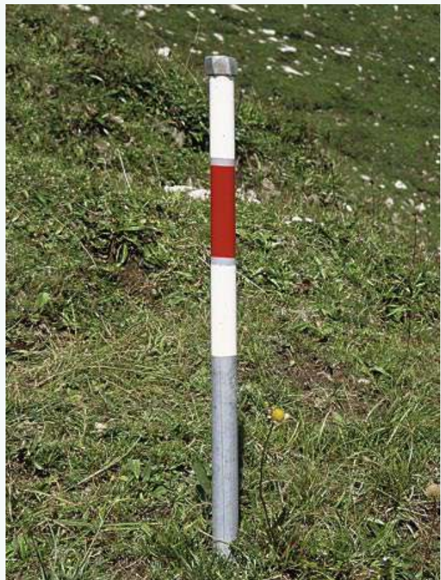
Rohr mit geringerem Durchmesser und größerer Markierung
